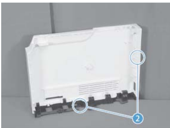
图 1-11 拆除左盖板，双面打印产品（第 2 张，共 2 张）
