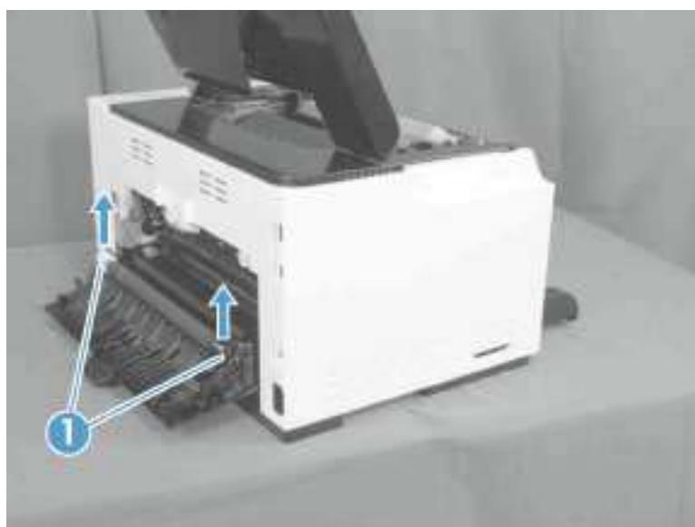
图 1-4 拆除二级转印滚轮
